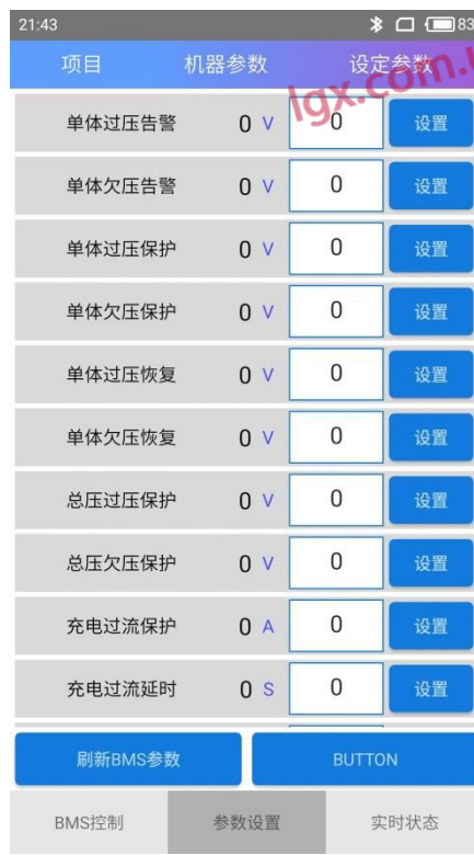
BMS 系统参数设置
